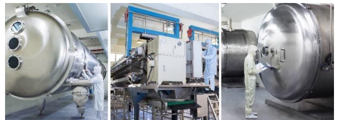
圖三、分離純化量產設備(左：連續真空帶式乾燥機；中：自動清洗隔膜式板框壓濾機；右：噸級冷凍乾燥設備)
