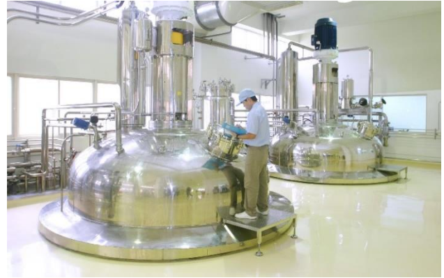
圖二、50噸發酵槽，連結全自動線上品質監控系統。
